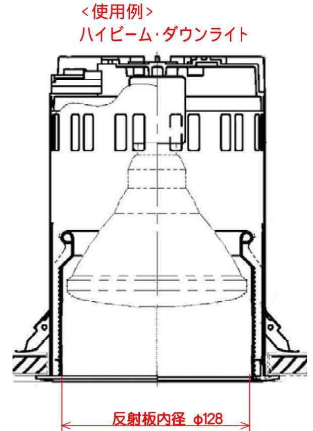
目視でランプと反射板の隙間に指先(5mm程度)も覗きそうになかったら
